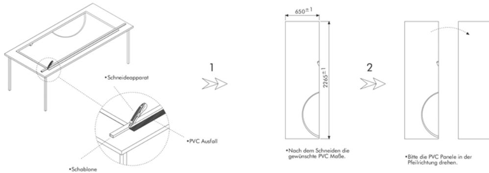
•Um den Druck auf der PVC Panele nicht zu beschädigen bitte je nach Mass schneiden.
