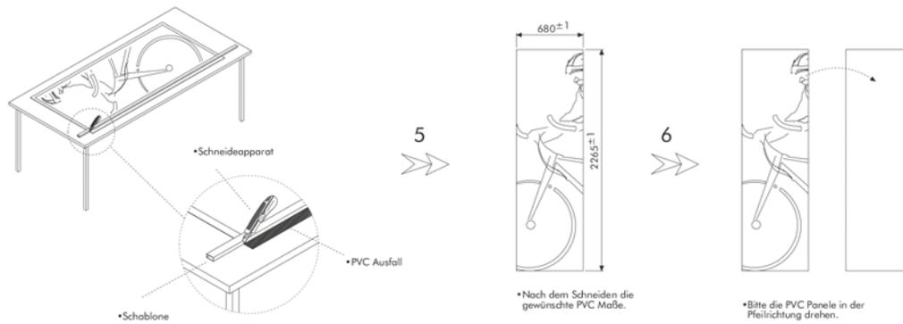
•Ohne den Druck auf dem PVC Paneele zu beschädigen mit den Hilfsmitteln sorgfältig je nach Mass schneiden.
