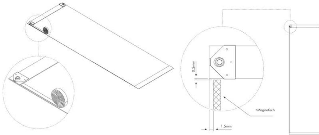
•Von oben und unten Teil lassen und das magnetische Kleben erfolgen. Bitte diesen auch für die anderen Panele Ausführen.
